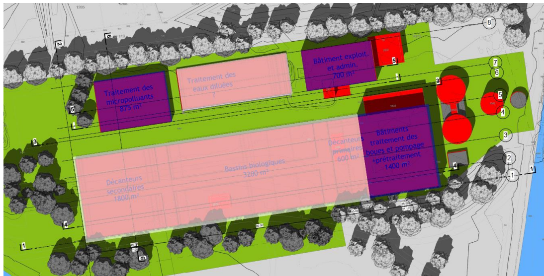
Figure 4 Surface de toit pouvant être recouverte. En bleu, les surfaces possédant un toit pouvant être recouvert après l'assainissement. En blanc, surface pouvant être recouverte avec un toit pliant.
