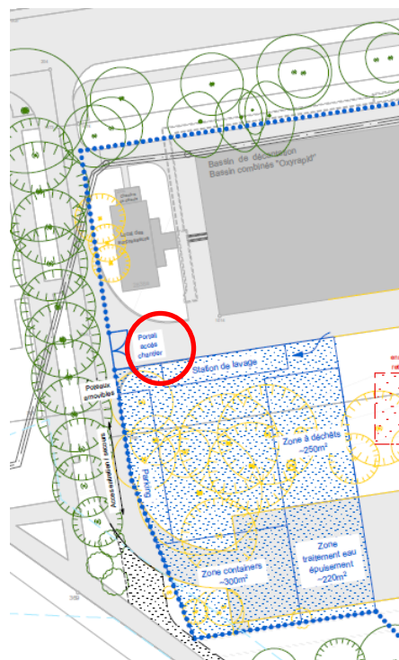
Figure 12: Installation de chantier et accès
